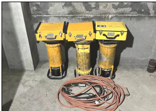
图 3-9 探伤机及电缆
